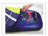
Öffnen Sie den schwarzen Ventildeckel, entgegen den Uhrzeigersinn.
