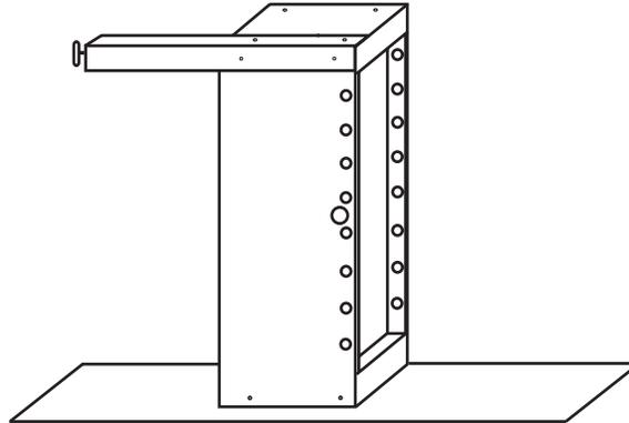
Kippen Sie den Tisch auf die zwei montierten Beine. Anschließend hebt eine (oder mehrere) Person(en) den Tisch auf der Seite ohne Beine hoch und eine weitere Person schraubt die Beine fest. **Achtung: Kippgefahr!**
