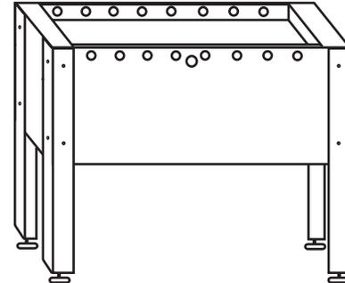
Stecken Sie die Balleinwurfschalen in die dafür vorgebohrten Löcher und benutzen Sie die mitgelieferten Schrauben (3 x 20) zur Befestigung. Die Schraublöcher sind angekört.
