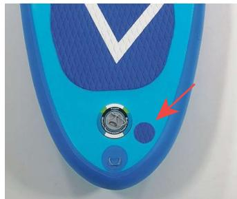
Pressen Sie die Folie nun mit viel Druck auf die undichte Stelle. Beschweren Sie das Patch mit einem Gewicht und lassen den Klebstoff ca. 12 Stunden trocknen. Danach geben Sie nochmals Klebstoff auf den Rand der Reparaturstelle und lassen alles nochmals 4-5 Stunden aushärten.
