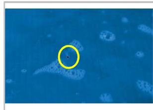
Besprühen Sie nun systematisch das Board mit einem dünnen Wasserfilm. Wenn kleine Luft und Seifenblasen austreten, haben Sie das Loch lokalisiert.
